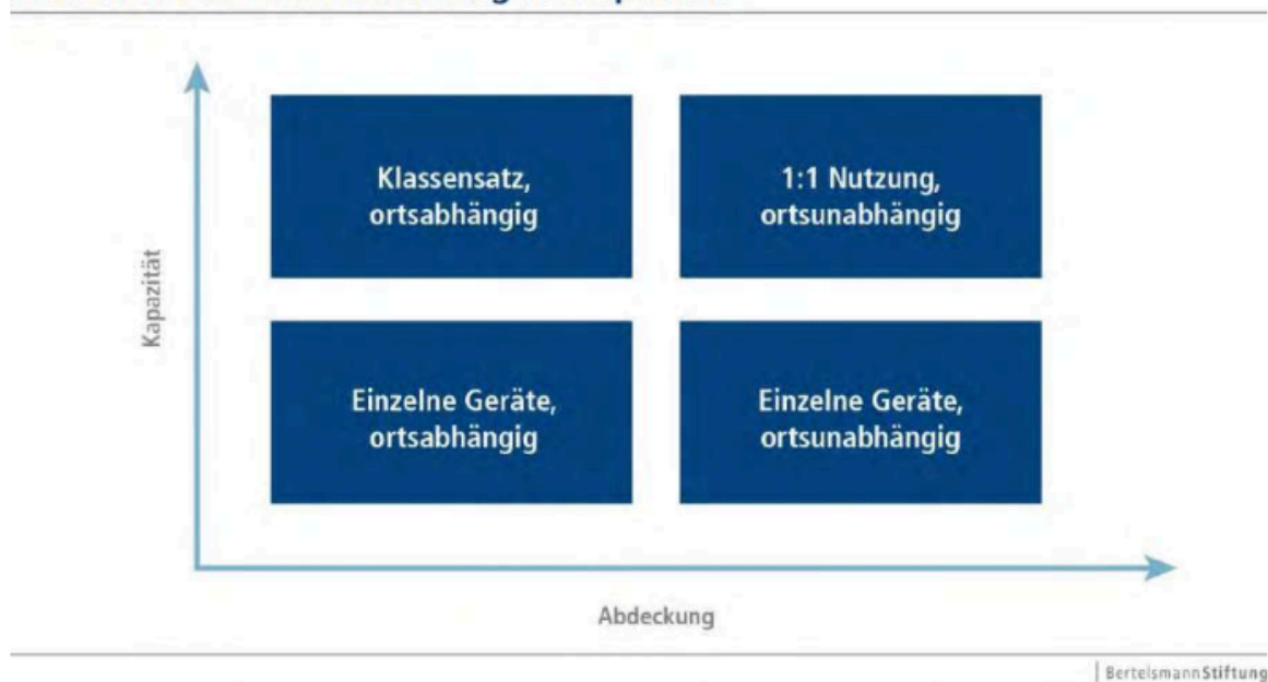
Abb. 3: WLAN – Ziel Abdeckung vs. Kapazität
