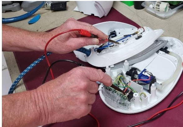
Bild 3: Reparatur eines Dampfbügeleisens Quelle: Meinhard Pupkes, Reparatur-Café Fix & Fertig
